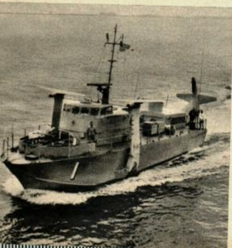
La canonnière « Flagstaff » construite par Grumman. Configuration classique. Mêmes caractéristiques que le « Tucumcari » et même propulsion diesel petite vitesse à jet d'eau sous-pression. La propulsion principale est assurée par une turbine Rolls-Royce « Tyne ».
