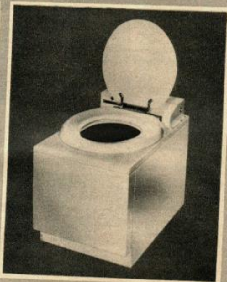
Le Raritan « Crown Head » comporte un broyeur et un injecteur automatique de chlore. Décharge en eau-libre.
