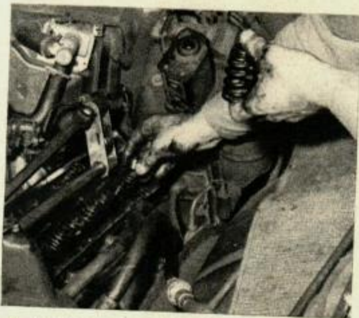
LES JOINTS DE SOUPAPE SONT ENLEVES et jetés, et lorsque vous montez de nouveaux joints, montez aussi les ressorts et assises, rassemblant le montage et remplaçant le culbuteur, assurez-vous que chaque pièce est absolument propre.
