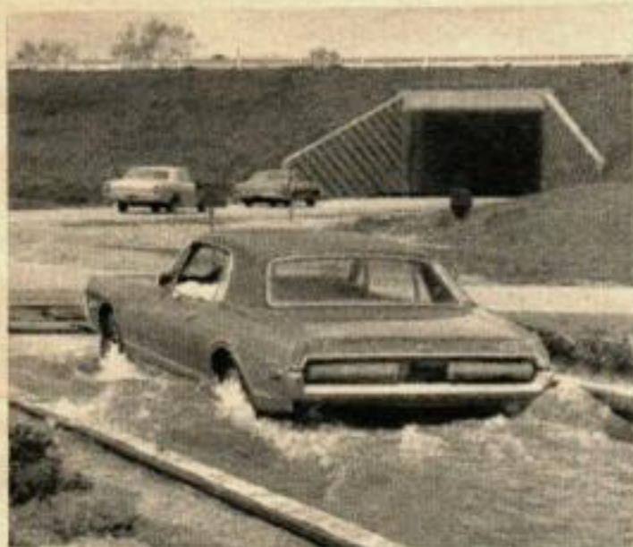
La Cougar prend un bain d'eau salée toutes les heures, pendant son circuit d'endurance de 40 000 km, à l'usine Lincoln-Mercury.
