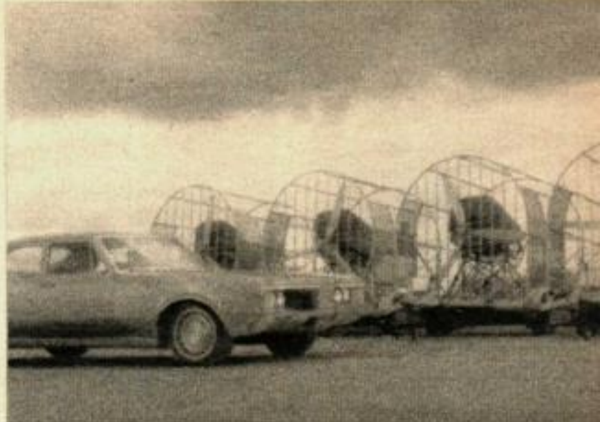
Des vents contraires à puissances contrôlées, sont produits par d'énormes moteurs d'avions, au terrain General Motors.
