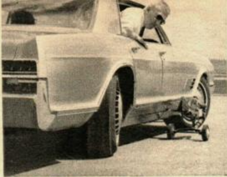
Les roues arrière dirigeables font partie de la voiture d'essais de la G.M., qui permet de reproduire différentes manœuvres de conduite.
