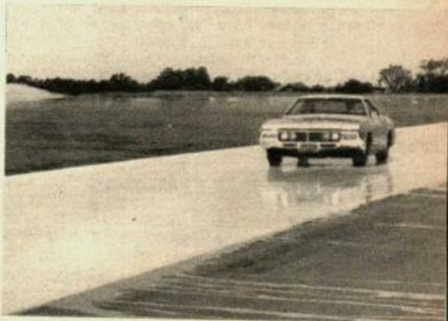
Cette surface lisse, au terrain d'essai de la General Motors, à Milford, Mich., est utilisée pour la mise au point de freins indépendants sur les quatre roues.
