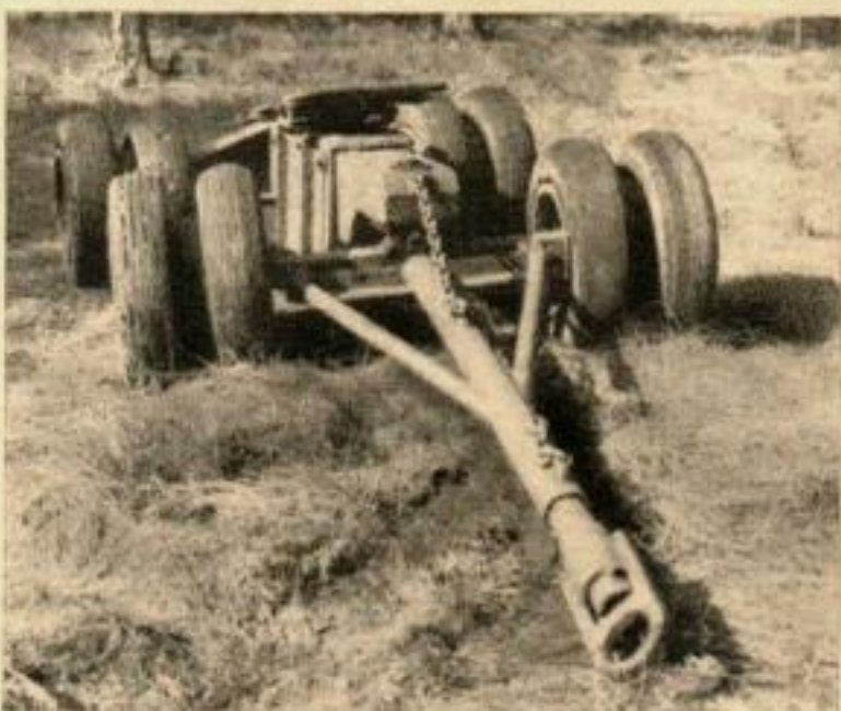
LE MATERIEL DE DEMENAGEMENT est un boggie de 8 roues montées sur deux essieux à suspension indépendante. Les essieux peuvent s'incliner et tourner pour suivre les accidents de terrain sans déranger le chargement.
