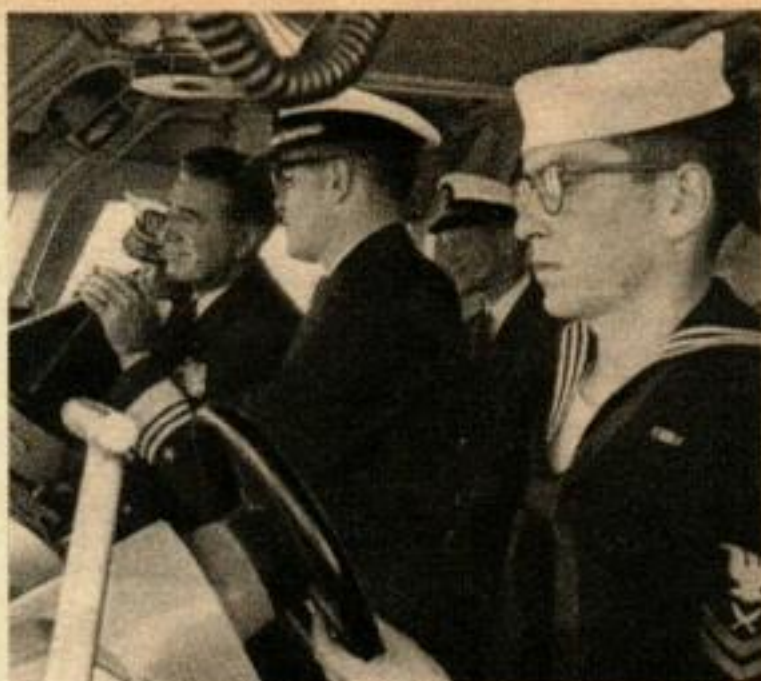
SUR LA PASSERELLE DU P.G., l'homme de barre (à droite), manœuvre un simple volant. On voit au premier plan la manette des gaz du turbopropulseur.
