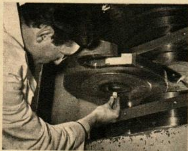
Presse travaillant à haute température mise en œuvre pour la synthèse du diamant à l'usine De Beers de Shannon (Irlande). La transformation graphite-diamant s'effectue quand la pression atteint 70 t/cm 2 et la température approche 2 800° C.
