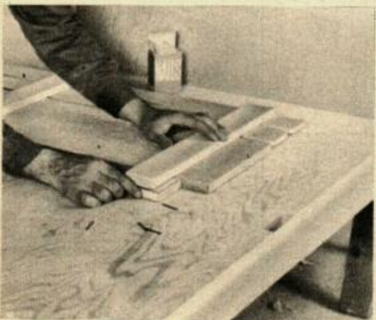
ALIGNER EXACTEMENT les montants latéraux en utilisant une cale de bois comme guide de position verticale.
