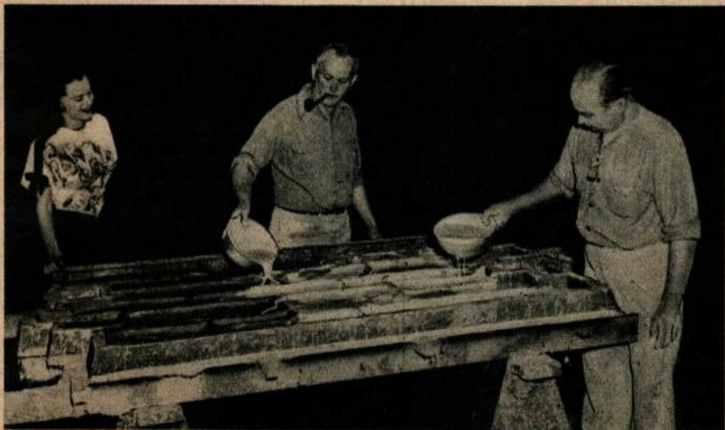
Les plâtriers du cinéma coulent des rochers qui paraîtront naturels aux yeux des spectateurs.
