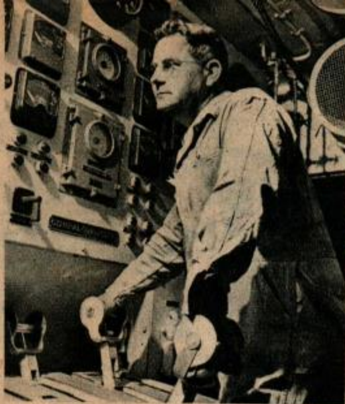
A gauche, la vitesse et l'inclinaison des hélices sont réglées depuis le panneau de commande de la propulsion. A droite, un quartier-maître dirige le navire à la barre aux approches du port tandis qu'un officier surveille l'écran du radar.
