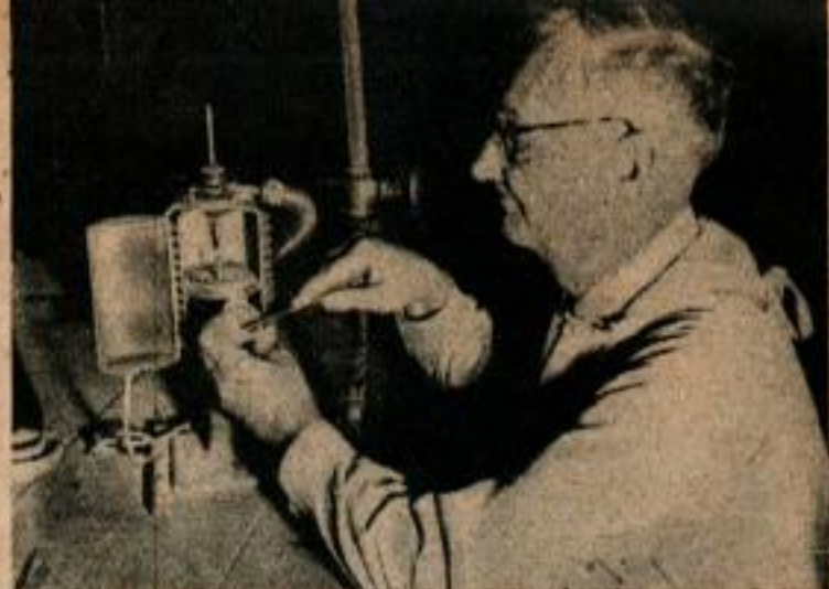
Les cendres de la plante étant placées dans la coupelle propre de l'électrode, l'expert se prépare à en faire l'étude au spectrographe.
