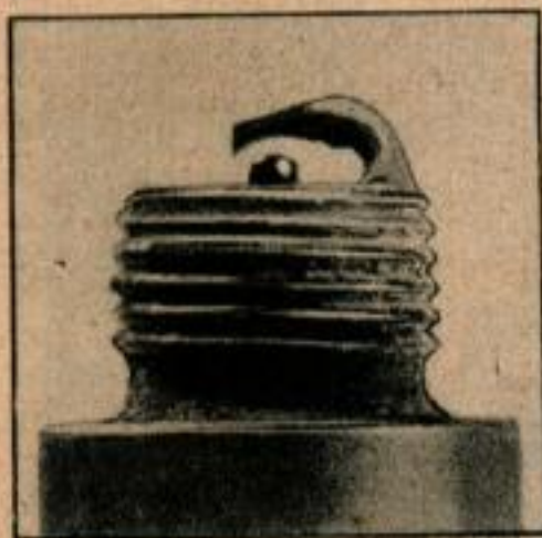
Ceci arrive quand une bougie fonctionne à trop haute température. Une usure excessive des électrodes apparaît au bout de relativement peu de temps.
