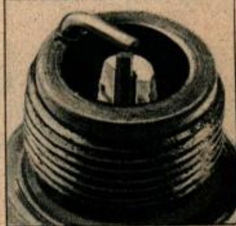
L'isolant brisé à la base peut être dû à un fonctionnement à trop haute température ou à une mise en place sans soin.
