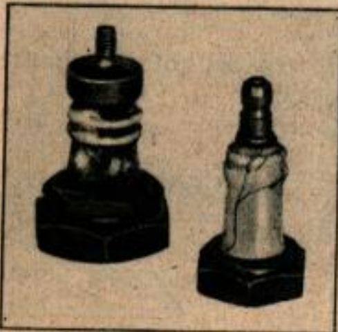
Des isolants cassés, sales, affectant le fonctionnement du moteur, provoquent des fuites à la compression, des courts-circuits et de la perte en carburant.
