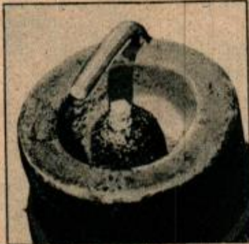
D'après des essais sérieux, les bougies dans cet état peuvent faire gaspiller 10 pour cent de carburant.
