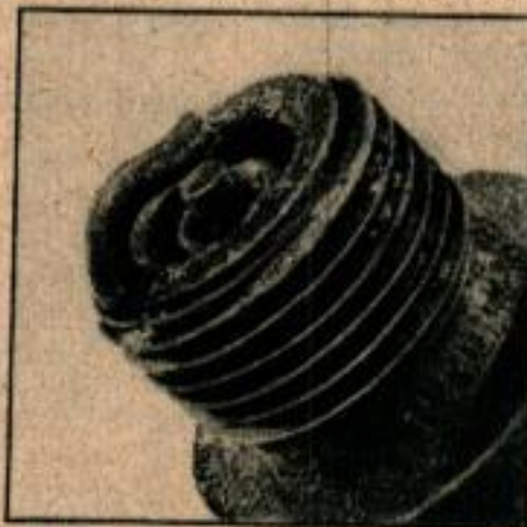
La bougie fonctionne à trop basse température. L'enveloppe, les électrodes et l'isolant sont encrassés par des dépôts de calamine dure.
