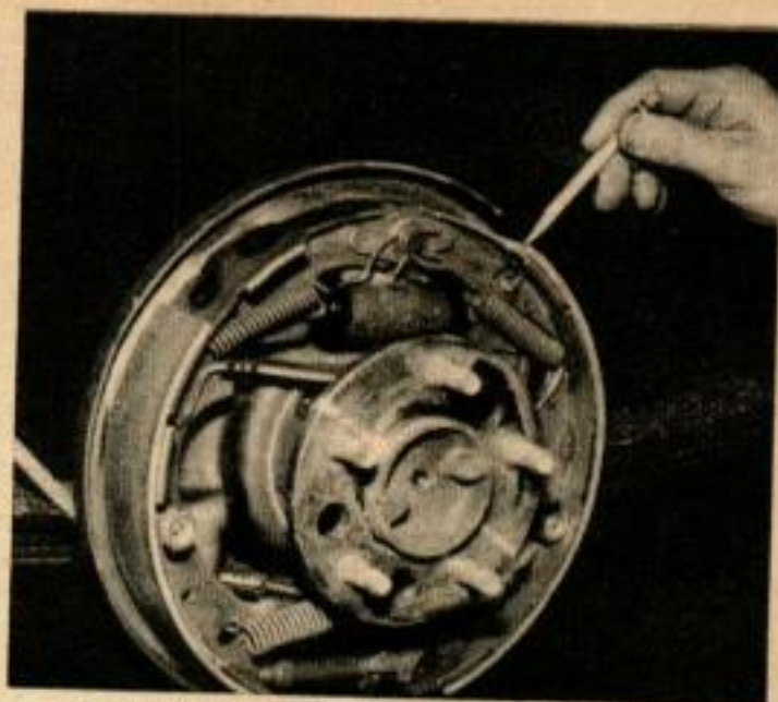
LES GARNITURES DE FREIN doivent être examinées sur toute leur surface pour que l'usure inégale ne passe pas inaperçue.
