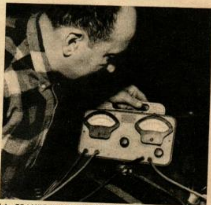
LA GRANDE MISE AU POINT doit comprendre une vérification de la tension de démarrage et du courant de charge de l'alternateur avec un voltiampèremètre.
