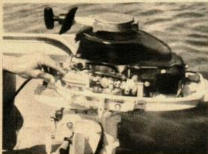
LE BOUCLIER DE RETOUR DE FLAMME est l'un des nombreux traits intéressants du 7,5 CV. Noter l'accessibilité de toutes les pièces ainsi que la disposition judicieuse des fils.
