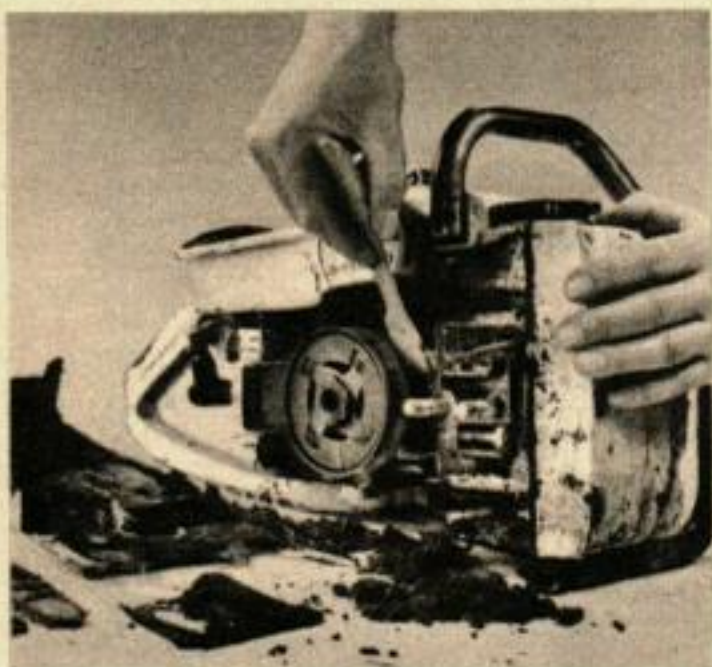
NETTOYEZ LE PIGNON d'entraînement régulièrement avec une spatule en bois, essuyez avec un chiffon imprégné de solvant.
