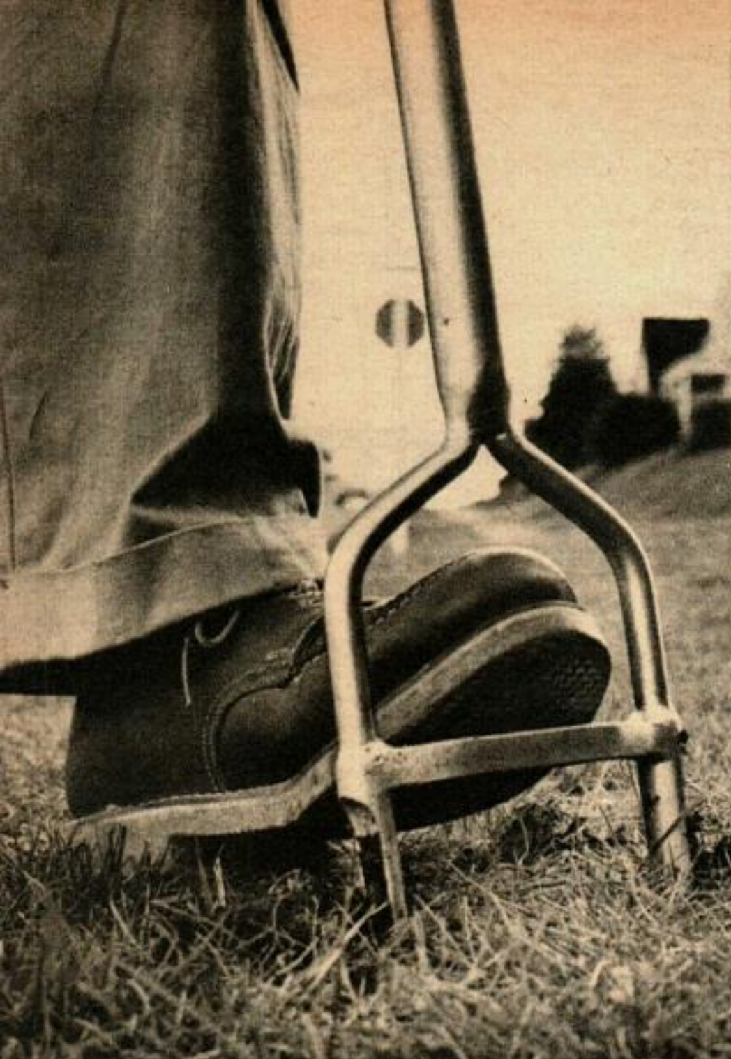
LES PERFOREURS DE GAZON sont des bouts de tube d'acier avec des rainures latérales pour faire tomber la terre.
