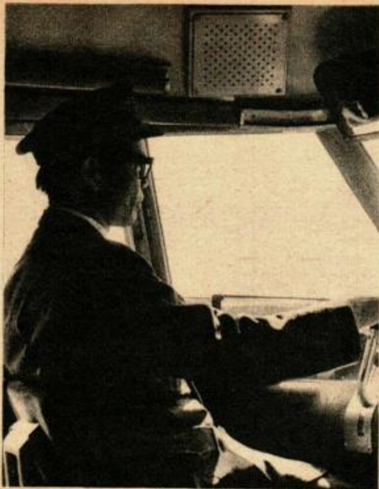
LE CONDUCTEUR TAKASHI TOMIIE saisit la manette de puissance avec la main droite ; à côté, se trouve la commande de marche arrière.
