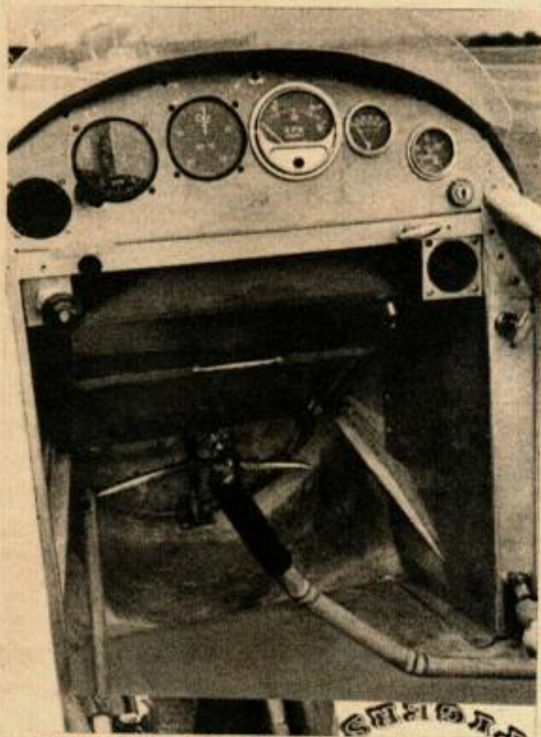
LA DISPOSITION TRES SIMPLE de la carlingue comprend les instruments de base, le manche décalé, le palonnier et les tringles de commande.
