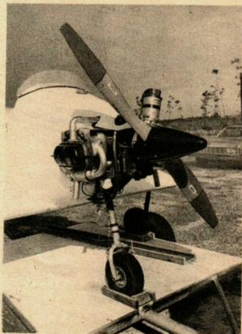
LE MOTEUR VOLKSWAGEN est le noyau autour duquel on a fait les plans de l'avion. Le train tricycle est constitué de trois roues de kart.
