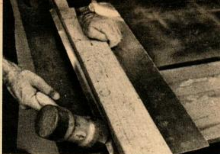
LA TECHNIQUE DE CONSTRUCTION très simple utilise un marteau en plastique pour plier le métal, éliminant ainsi les dispositifs compliqués.
