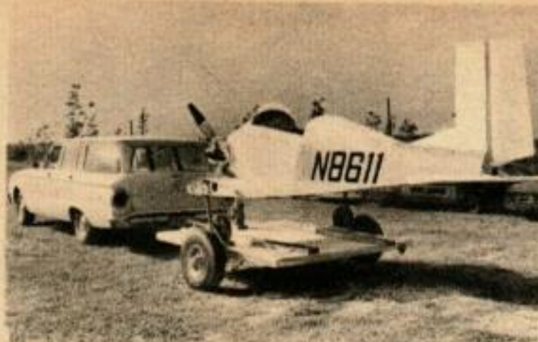
LE TEENIE A DES AILES DEMONTABLES qui peuvent être rangées dans la camionnette tandis que l'avion est remorqué.
