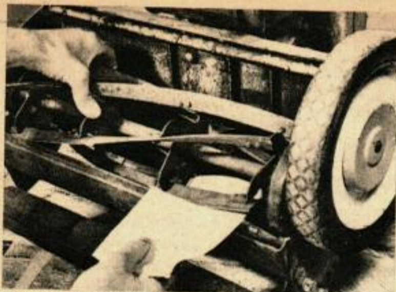
AVEC UNE TONDEUSE A MOULINET, il faut vérifier l'alignement des lames avec le couteau en coupant un morceau de papier avec chacune des lames.
