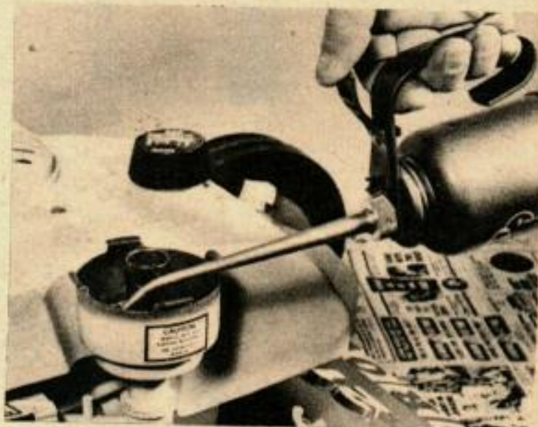
POUR NETTOYER UN FILTRE A AIR à bain d'huile, il faut le démonter et bien le rincer, puis le nettoyer, le remonter et refaire le plein d'huile.
