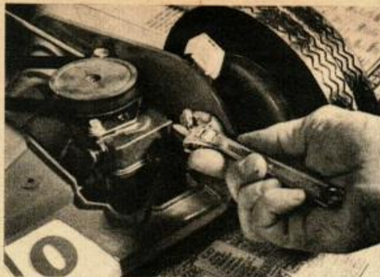
REGLER LA TENSION DE LA COURROIE avec la poulie libre ou en calant la boîte de vitesse, comme montré ci-dessus.
