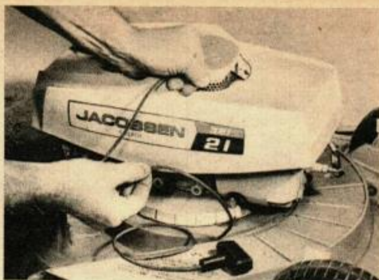
VERIFIER LE CORDON DE LANCEMENT sur toute sa longueur, pas seulement sur le bout qui sort du capot. S'il est usé, il faut le changer.
