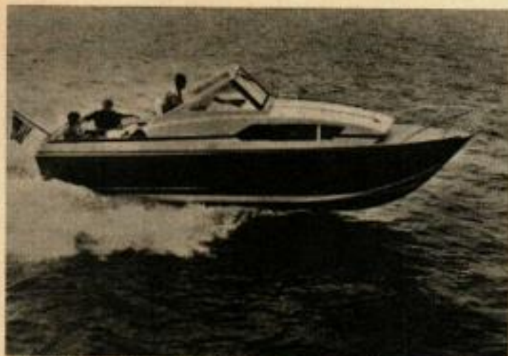
LE CHRIS-CRAFT FUTURA, une version galbée du 7,90 m de la série Cavalier, a une coque en contre-plaqué marine peinte de rouge vif. Une carène en fibre de verre peut-être posée sur demande.
