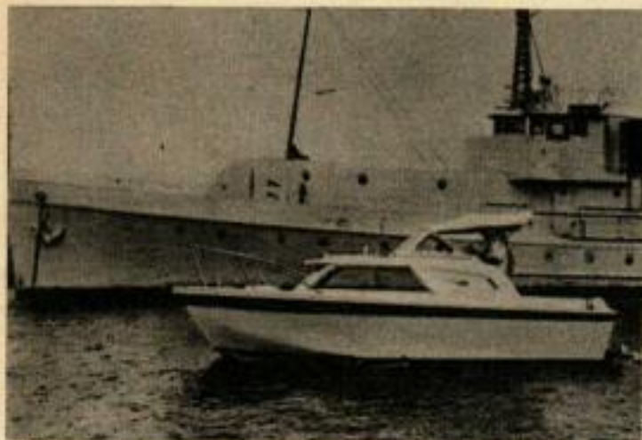
L'UNIFLITE 20 est un croiseur trapu en fibre de verre avec 2 couchettes dans une cabine qui a 1,50 m de hauteur sous barrot. Il est normalement équipé d'un moteur de tableau de 155 CV.
