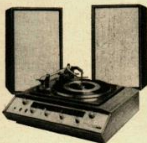
LE HARMAN-KARDON SC 440 est facile à reconnaître par son tableau incliné à l'avant. Comme sur la plupart des compacts, le tableau du devant porte un jack pour l'écouteur stéréo.
