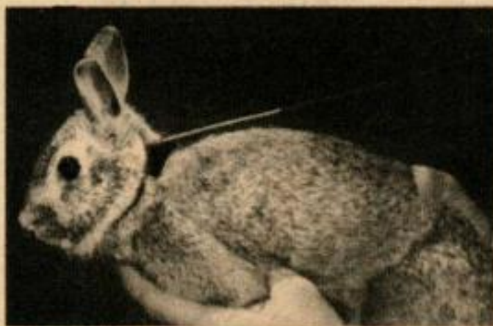
CE LAPIN PORTE UN ÉMETTEUR fixé sur un collier, alimenté par batterie et muni d'une antenne-fouet (photo) ou cadre.
