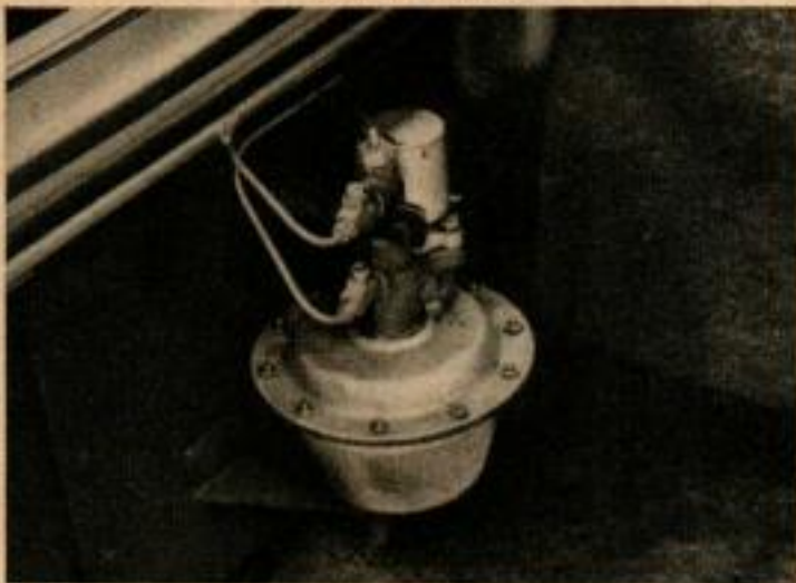
LE DISPOSITIF DE COMMANDE des freins du système Kelsey Hayes assure automatiquement un freinage discontinu en cas de dérapage jusqu'à l'arrêt de la voiture.
