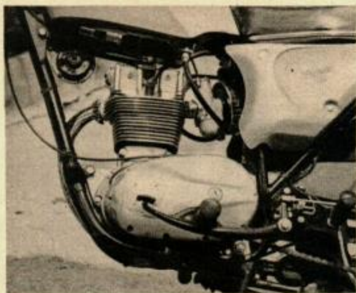
LE MOTEUR EST BIEN REFROIDI et pratiquement impossible à surchauffer, mais les ailettes font un bruit bizarre au ralenti.
