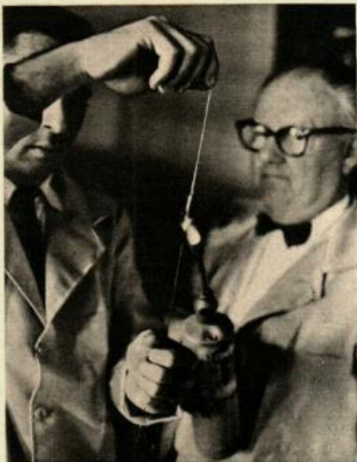
UNE NOUVELLE FIBRE réalisée par la Celanese Corp. peut supporter (on en voit une démonstration ci-dessus) une température de 180° C pendant de longues périodes ou de plus de 500° C pendant de courtes périodes sans perdre sa résistance. Sous le nom de polybenzimidazole, cette fibre est étudiée pour la fabrication des parachutes de freinage des avions à réaction.
