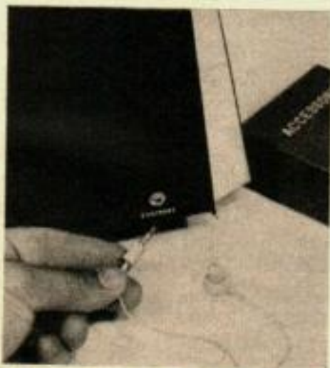
L'ECOUTEUR SUPPLEMENTAIRE branché sur un jack du poste permet l'écoute pendant les heures tardives. Comme accessoires, il y a encore le chargeur de batterie et les antennes d'auto ou de bateau avec montures.
