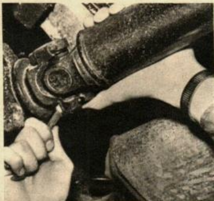
D'ABORD, ENLEVER LES BOULONS DE CHAPE qui maintiennent le cardan arrière (différentiel).
