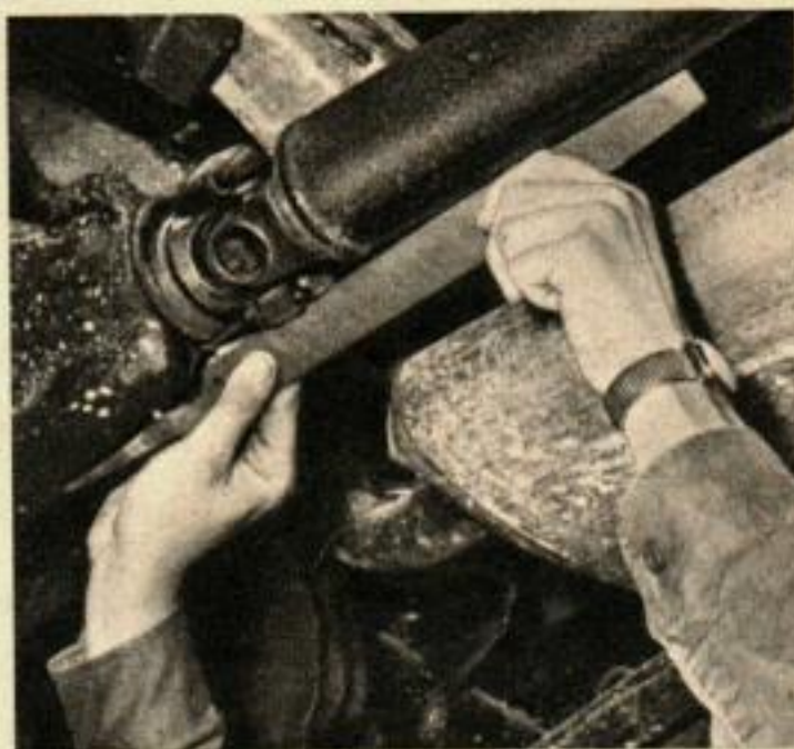
GRAVER UNE MARQUE correspondante sur le cardan et la chape du différentiel pour pouvoir aligner les pièces au remontage.
