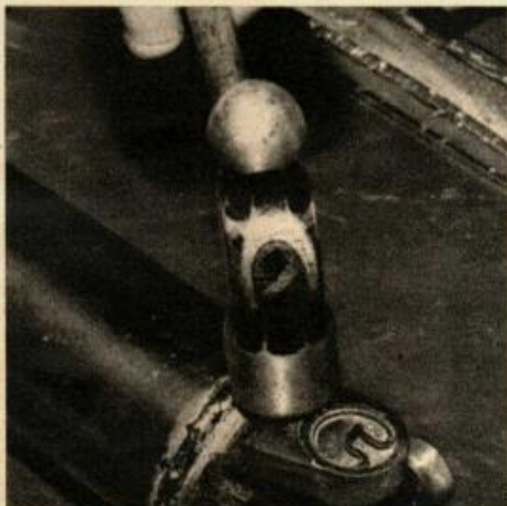
EN DONNANT DE PETITS COUPS sur la chape, on fait sortir les chapeaux de palier. S'ils ne sortent pas, il faut les extirper.
