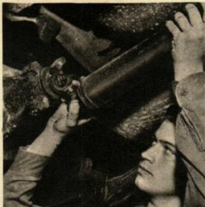
ABAISSEZ LE BOUT ARRIERE de l'arbre de transmission du différentiel avec précaution, juste assez pour le dégager.
