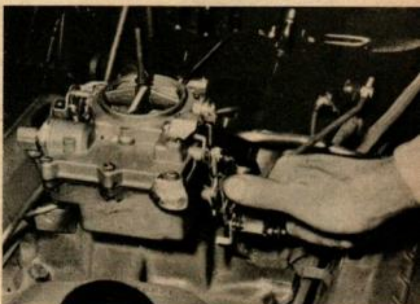
DEGIVRER LE CARBURATEUR en manœuvrant prudemment les volets de gaz. Pour empêcher l'incident de se reproduire, ajouter la proportion indiquée de produit dégivrant à l'essence.
