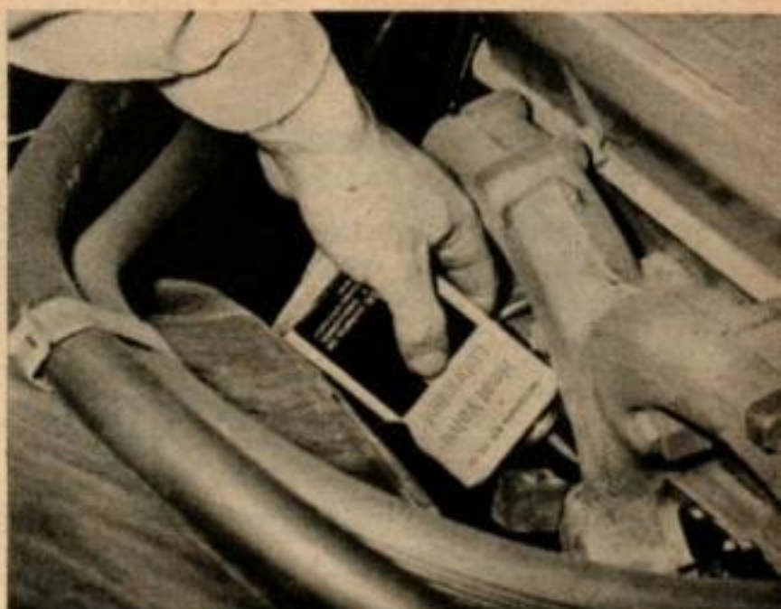
LE VOLET DE TEMPERATURE de tubulure qui est resté coincé en position ouverte empêche le moteur de chauffer rapidement. Il faut mettre de l'huile s'il ne tourne pas facilement.
