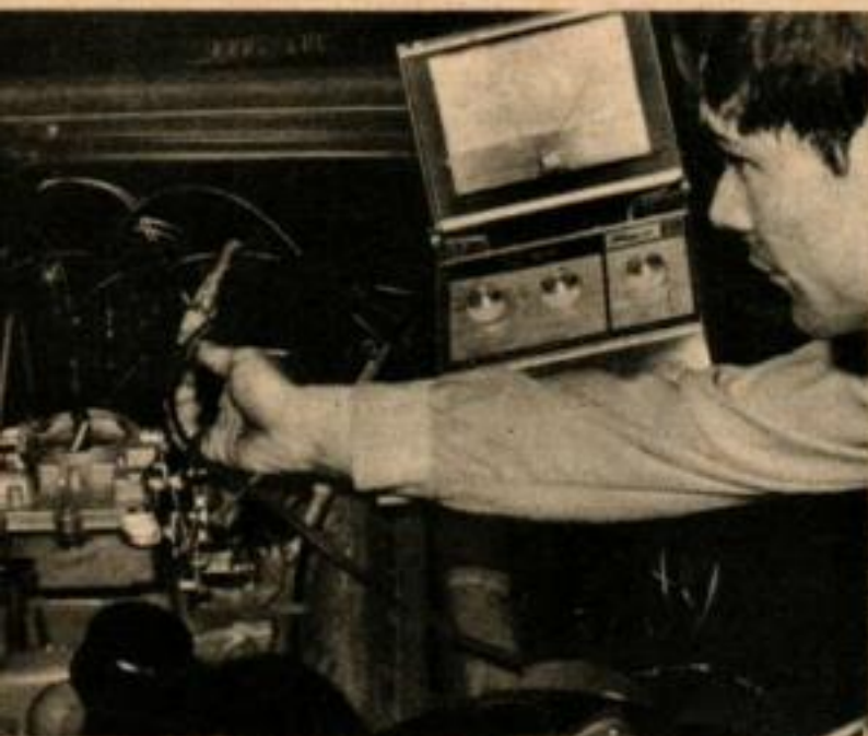
LE REGLAGE RALENTI rapide permet d'alimenter suffisamment le moteur froid pour qu'il ne cale pas. La vis qui s'applique contre la came est tournée pour faire le réglage.
