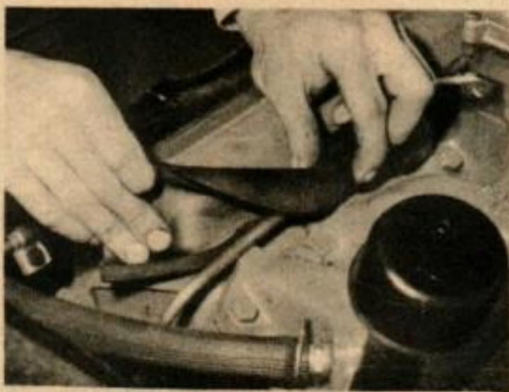
LE BOUCHON DE VAPEUR , qui ne peut manquer de caler le moteur, peut être éliminé une fois pour toutes, en couvrant les canalisations d'essence de mousse plastique ou d'un autre matériau isolant du même genre.
