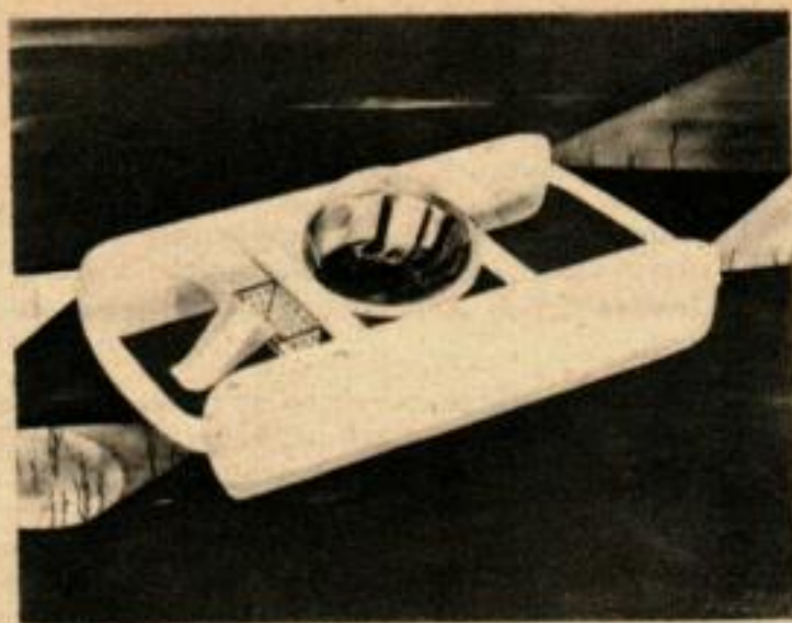
A gauche : LA MARINE U.S. fait des essais avec des sphères en verre pour des plongées profondes. Celle montrée a 105 cm de diamètre. Plus la pression augmente, plus le verre devient solide.
