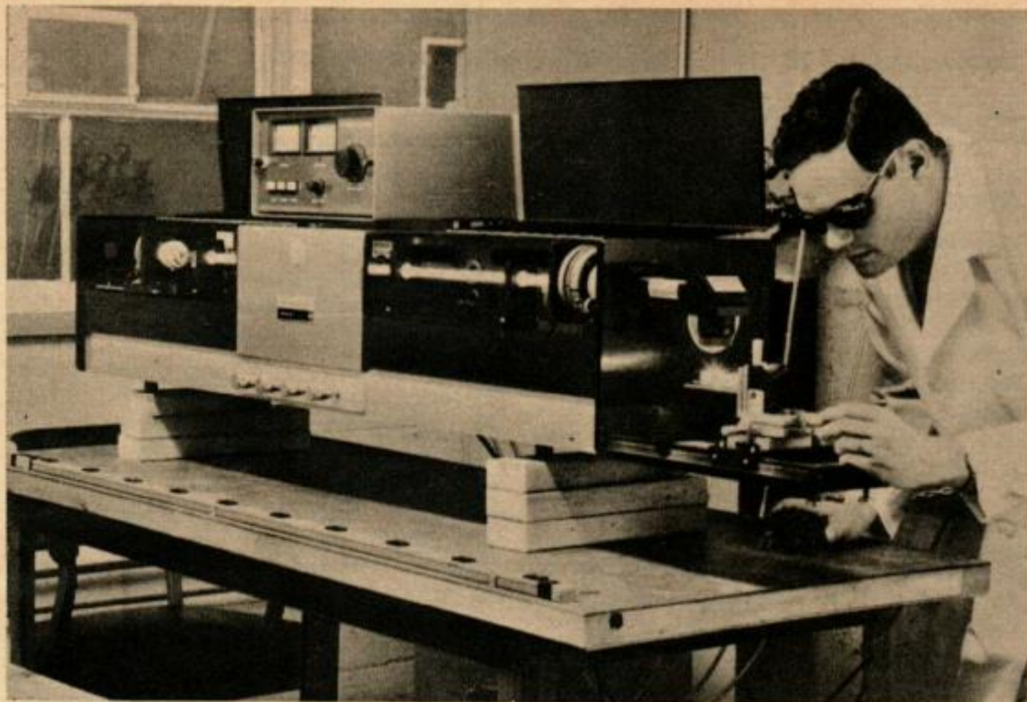
CI-DESSUS : un technicien règle un laser de moyenne puissance pour l'usinage, CI-DESSOUS : gros plan sur le laser à gaz carbonique, le rayon qui travaille est invisible. A DROITE : laser à gaz carbonique de 10 m de long, capable de produire un rayon infrarouge assez puissant pour traverser n'importe quelle substance connue.
