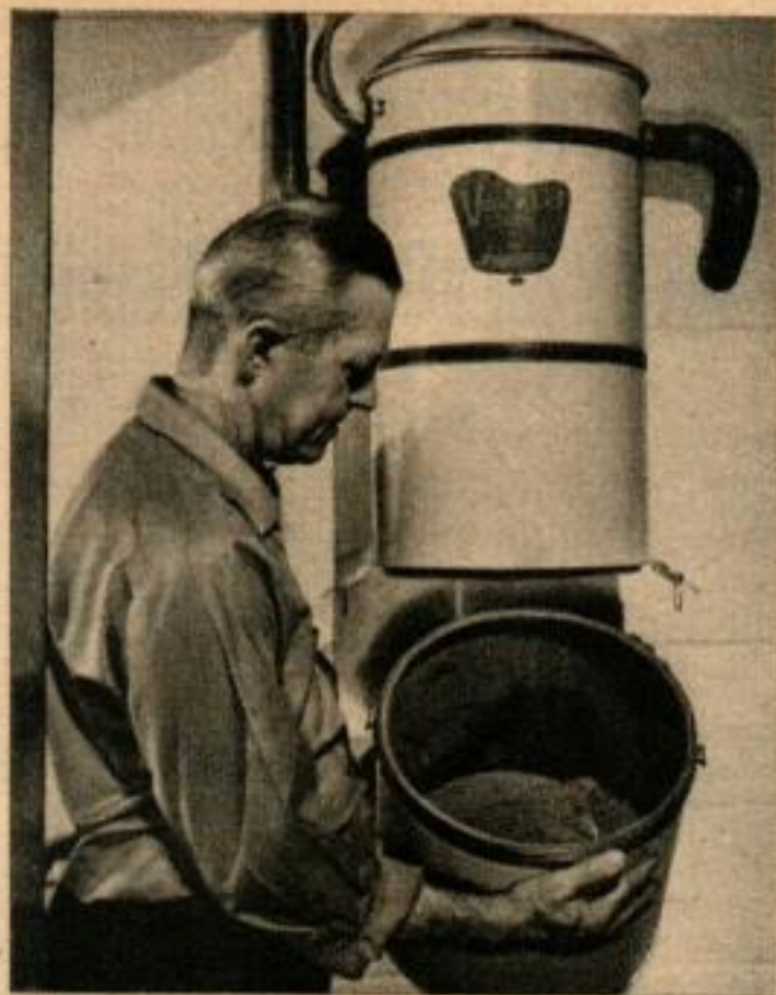
LE BAC A POUSSIERE est fixé sous l'aspirateur, il s'enlève et se remet en peu de temps ; sa contenance est de 12 litres.
