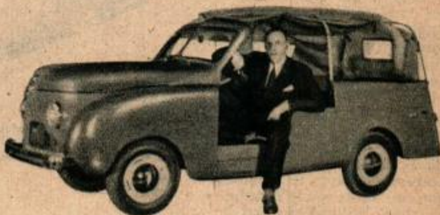
Le constructeur Powel Crosley présente un modèle destiné aux week-ends. Il peut transporter 2 personnes et 500 kg de bagages ou de marchandises. Ci-dessous, la Crosley utilitaire, un modèle mixte à carrosserie tout acier.
