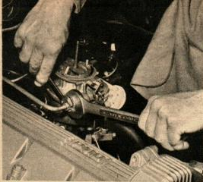
DEBRANCHEZ LE TUYAU d'arrivée d'essence pour voir si elle coule, mais attention, quand le moteur est froid.
