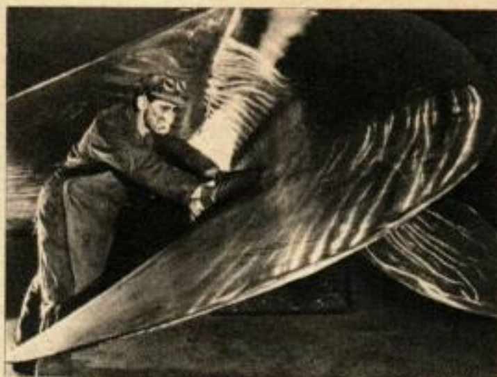
LES HELICES A SIX PALES mesurent 5,80 m de diamètre, les plus grandes de tous les navires à deux hélices.
