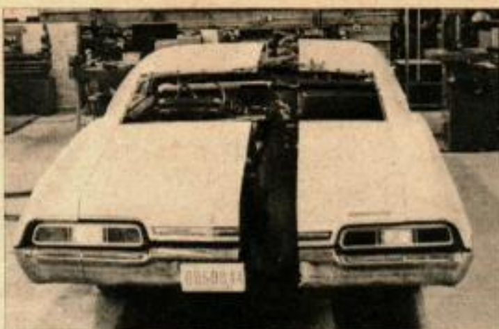
LA COUPE est en fait à droite de la ligne médiane pour laisser la transmission en état de fonctionnement. Le côté gauche peut rouler à 65 km à l'heure par ses propres moyens.
