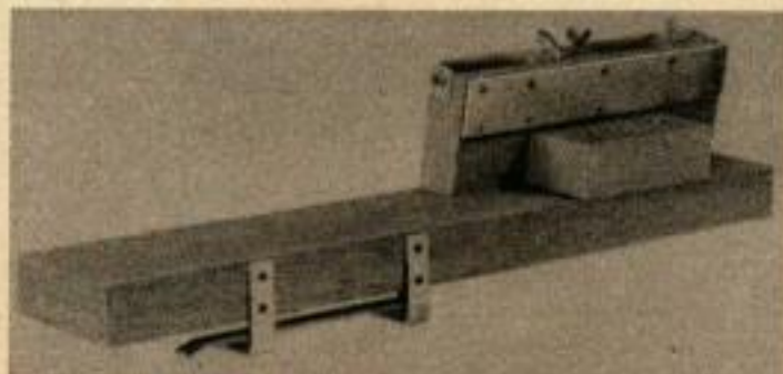
LES VUES de devant et d'arrière de l'étau à affûter les scies montrent son arbre de lame qui est réglable pour loger des lames de diverses dimensions (à gauche) et son patin de glissement qui sert à le tenir à la table de la scie pour les réglages initiaux.
