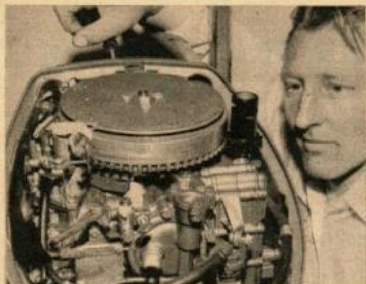
IL Y AURA DU BRUIT si une dent est cassée ; vérifiez le volant si le démarreur est bruyant.
