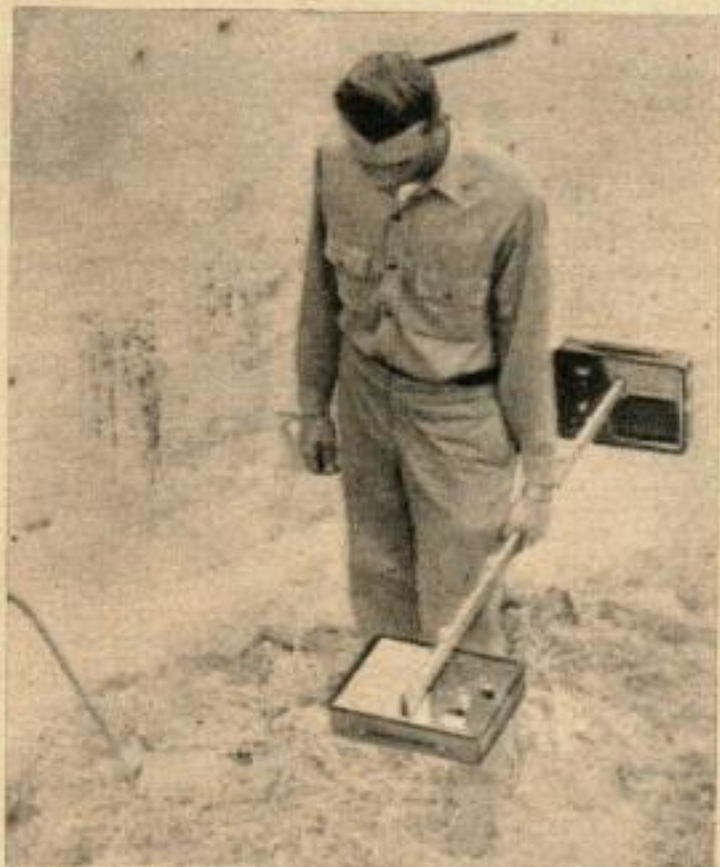
LE DETECTEUR DU GENRE RADIO possède deux boucles aux bouts d'une perche. Le signal émis par une boucle est réfléchi par les objets métalliques et reçu par la deuxième boucle.
