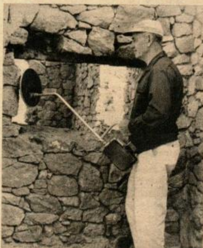
LE DETECTEUR A BATTEMENT DE FREQUENCE possède une seule boucle au bout de sa perche. Il émet un champ électromagnétique qui repère la présence d'objets métalliques.
