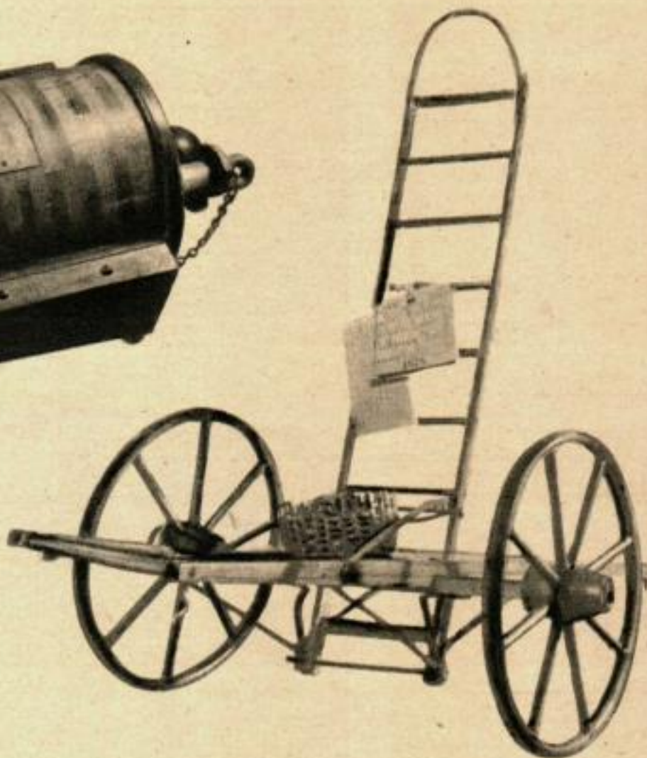
LA MITRAILLEUSE DE GATLING, ci-dessus, en bois, comprend des canons de fusil à chargement par la culasse groupés autour d'un axe central ; le brevet est de 1862. L'échelle roulante, à droite, avec son panier, était pour la cueillette des fruits.
