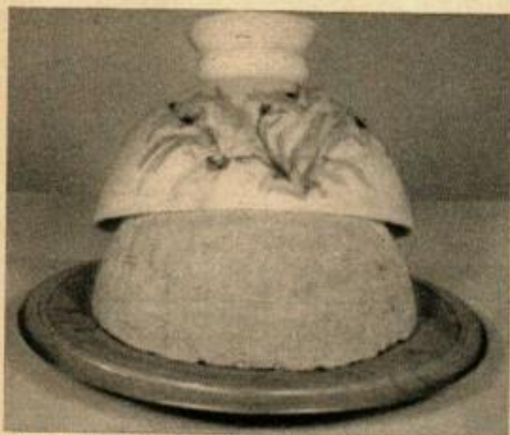
LA FORME autour de laquelle on construit l'abat-jour est moulée dans un plat et posée sur un tour.
