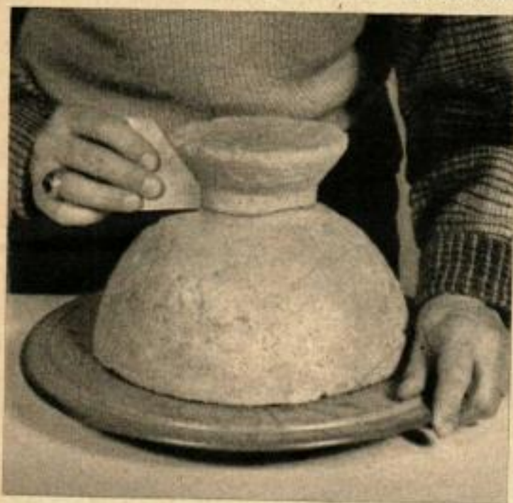
ON APPLIQUE LE GABARIT d'aluminium sur la forme qui tourne pour lui donner le profil désiré.
