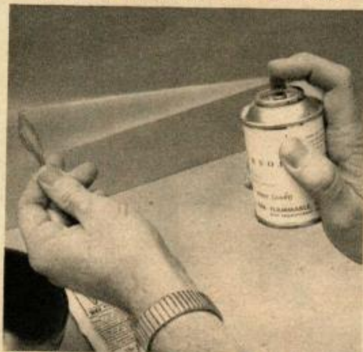
ON PASSE SUR L'ORIGINAL , ici une petite feuille, un agent mouillant avant de le noyer dans le moule. Ceci aide le mélange à bien pénétrer partout.
