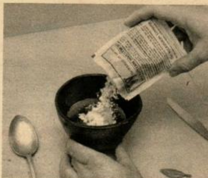
LE MATERIAU DU MOULE est versé dans un bol et mélangé à de l'eau pour donner une pâte crémeuse. Remuer doucement pour ne pas donner de bulles d'air.
