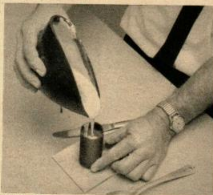
UN TUBE DE METAL , appelé anneau, sert de réceptacle pour le mélange du moule. Remplissez à ras. On verse plus facilement avec un bol souple.
