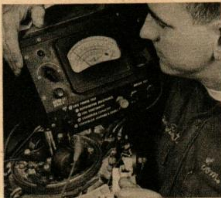
UN VERIFICATEUR DE MAGNETO indique si l'étincelle est bonne et si elle se produit au bon moment. L'allumage et la compression sont de première importance pour la vitesse.
