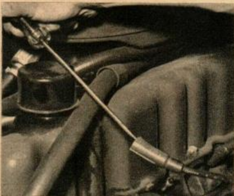
SI LE FIL DE BOUGIE est noyé dans le caoutchouc, on peut le mettre à la masse avec l'aide d'un tournevis.
