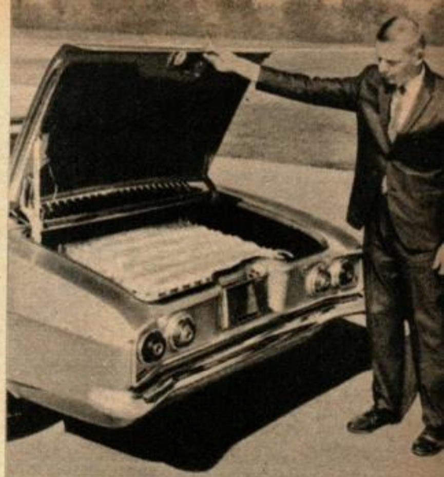
DES BATTERIES D'ELEMENTS ZINC-ARGENT emplissent l'avant et l'arrière de l'Electrovair (ci-dessus) et le siège arrière est encombré d'un labyrinthe de fils ; il n'y a plus de place pour grand-mère.
