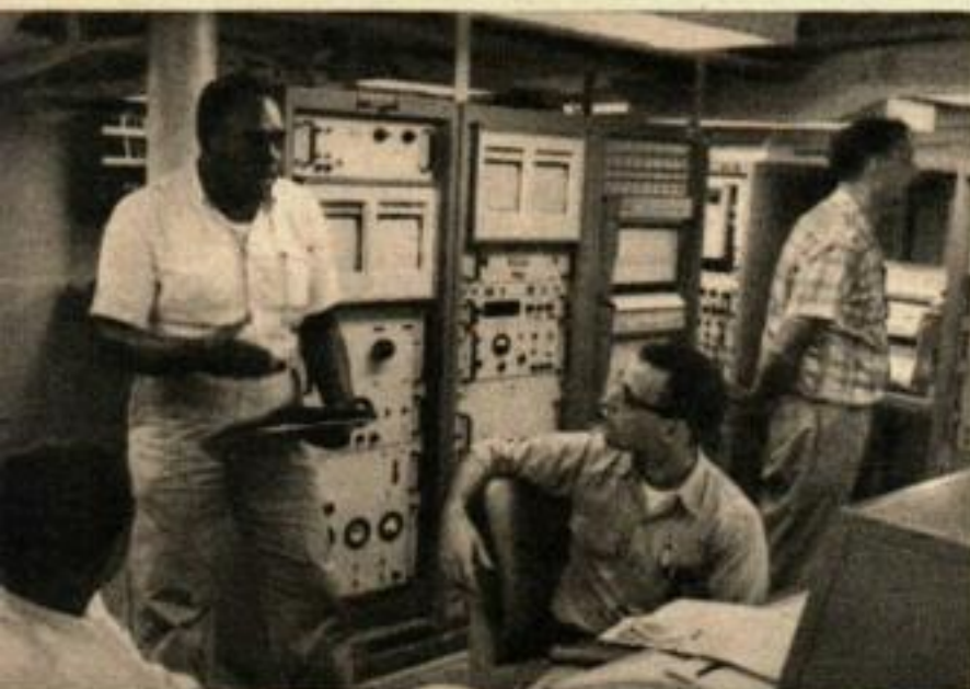
LE LABORATOIRE D'ENREGISTREMENT électronique est le cœur des divers appareils scientifiques du Silas Bent . Ici toutes les mesures sont enregistrées et fournies au calculateur électronique.
