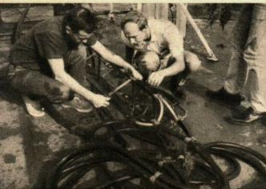
LES MEMBRES DE L'EQUIPE SCIENTIFIQUE vérifient l'éclateur et le débarrassent des herbes qui l'encombrent, après l'avoir tiré à la main. Le câble isolé transmet le courant électrique.
