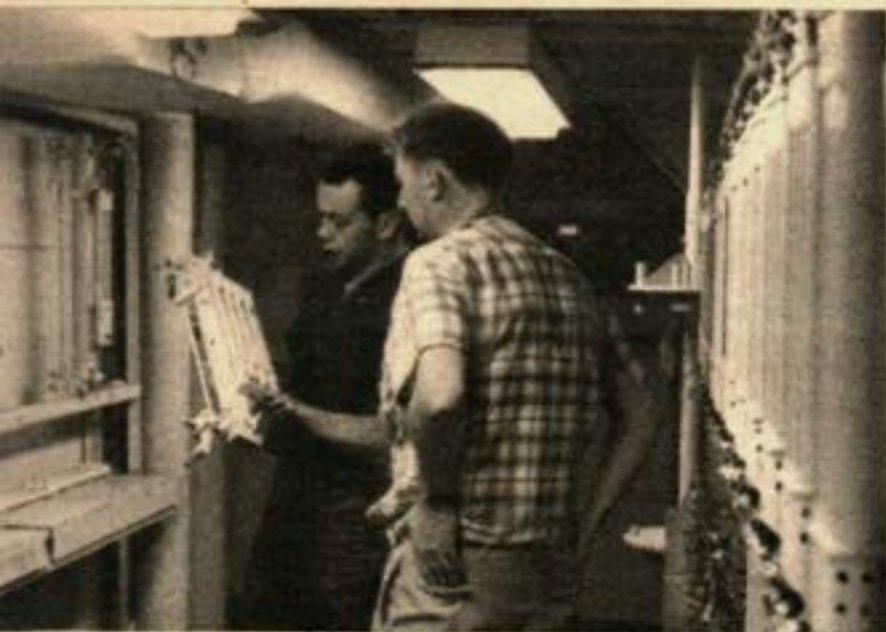
LES BOUTEILLES DE NANSEN sont rangées dans le labo « humide ». C'est un moyen déjà vieux mais toujours bon pour recueillir des échantillons d'eau à diverses profondeurs ainsi que la température.
