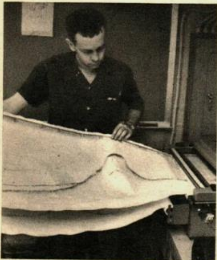
LE PROFIL POINTU du Seamount Muir apparaît sur l'enregistreur du laboratoire d'électronique. A gauche on voit les deux lignes distinctes qui représentent l'épaisseur des sédiments.
