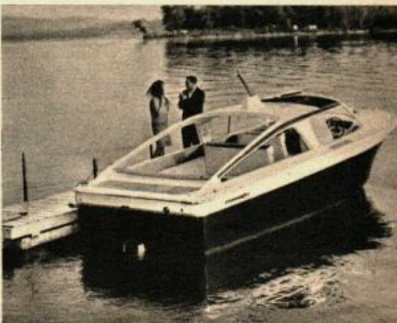
LE « BAR HARBOR » DE BUEHLER, 8 m de carène en V, doit sa ligne aérodynamique à Virgil Exner. Ce bateau de rêve à réaction est propulsé par une turbine avec des moteurs de 290 à 325 CV ; il emporte 240 litres d'essence et de la mousse plastique assure la flottabilité.
