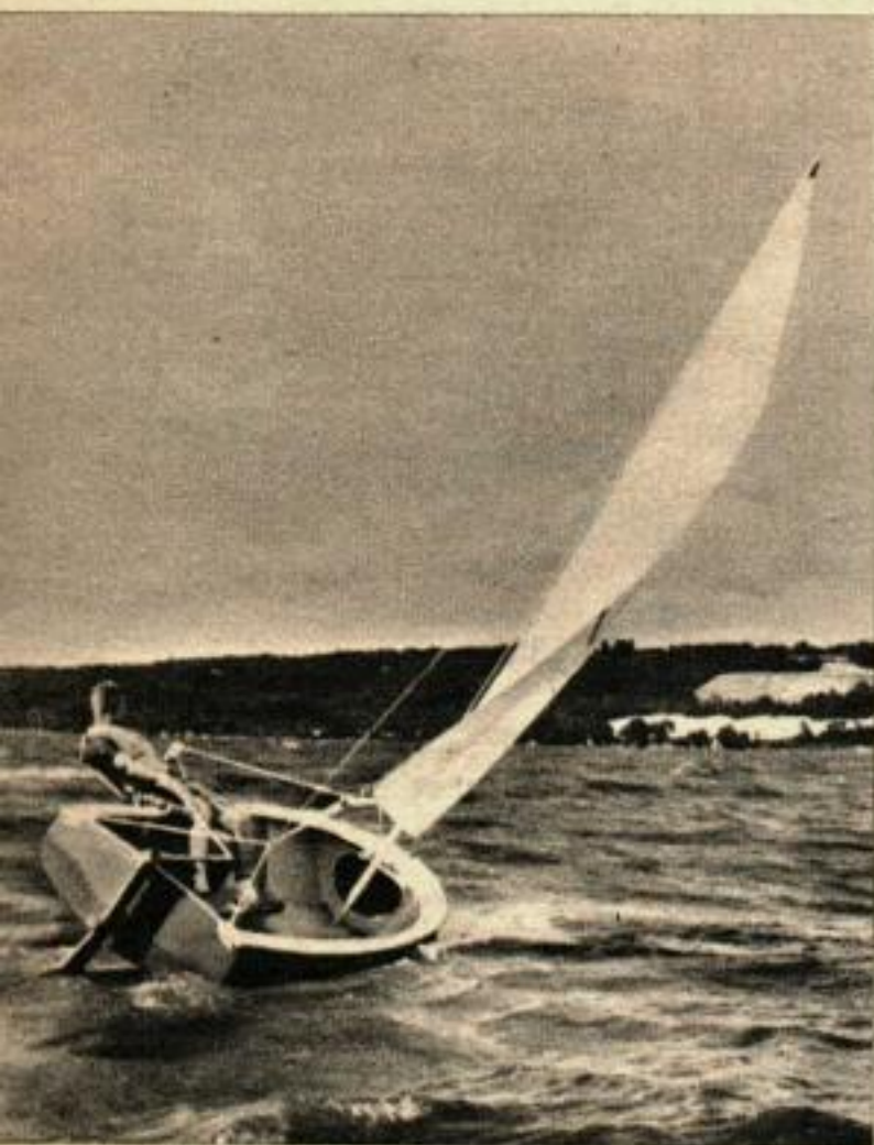
LE « BALLERINA » DE GRUMANN est l'un des nombreux bateaux en aluminium de la série 1967 de cette société. La coque de 4 mètres a de la mousse entre la sole (le plancher pour les profanes) et la coque. En somme, bien du sport pour un quatre mètres.
