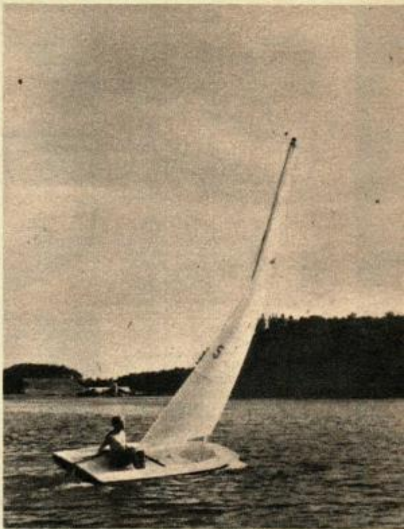
LE « REGATTA 132 » DE LARSON à 4 mètres de long, et 1,50 de large ; il porte 8 mètres de toile de Dacron. On peut le couvrir, pourtant son cockpit est assez grand pour qu'on puisse y mettre autre chose que les pieds. Mât, bôme, gouvernail et dérive sont en aluminium.
