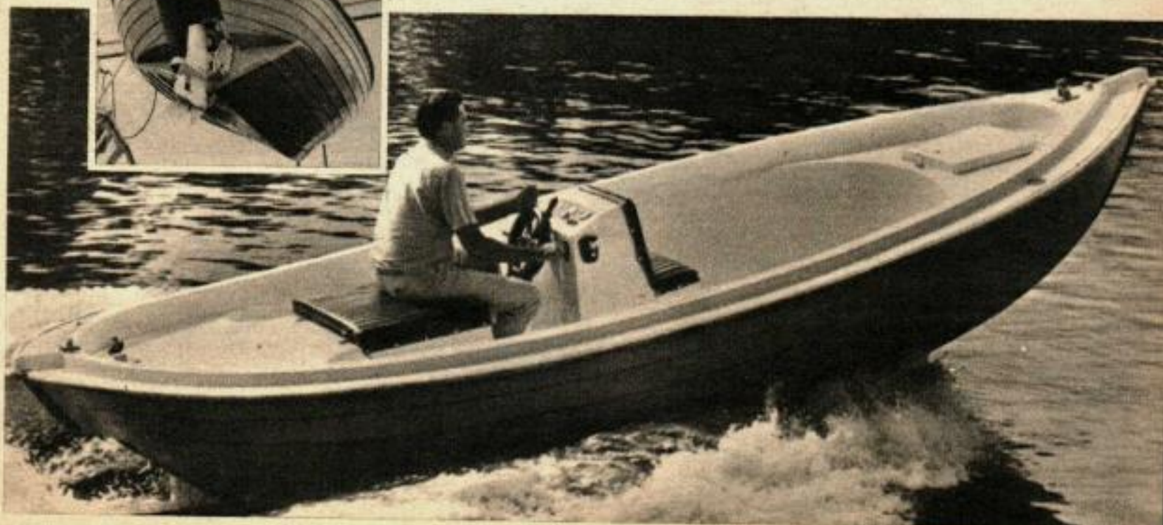
LE « FJORDLING » construit par la Lauderdale Marina Incorporated a la forme d'une barque, mais en guise de rames, il a un bon moteur Volvo de 110 CV en poupe. Tout en tissu de verre, il doit faire 48 km/h.
