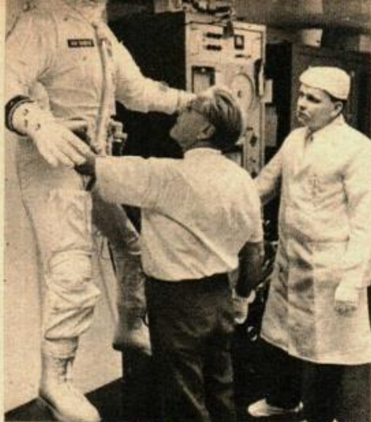
UN INSPECTEUR DE LA N.A.S.A. fait des visites régulières à l'usine de Clark pour examiner les combinaisons en cours de fabrication. Ici, on le voit gonfler l'habit pour voir s'il n'y a pas de fuites, comme une vulgaire chambre à air...
