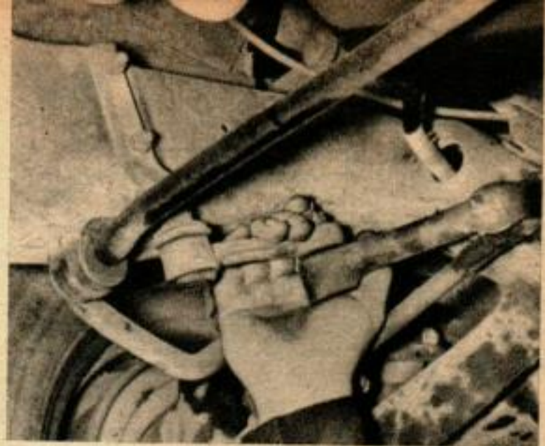
L'EXCES DE JEU DANS LA BIELLE libre est facile à vérifier. Comme on le voit, une de ses extrémités est fixée au châssis du côté du passager et l'autre tient à la bielle de connexion.
