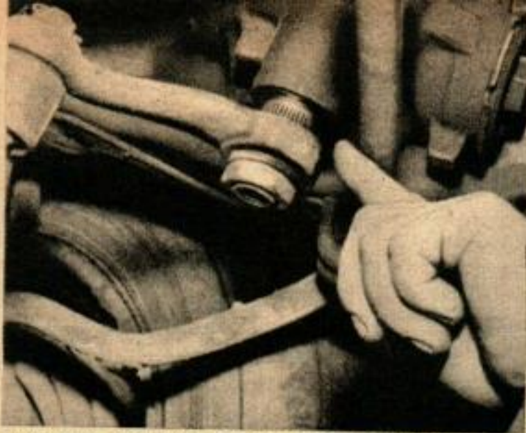
L'ARBRE DE BIELLE EST TROP GRAISSE quand l'étanchéité est mauvaise ; dans ce cas il faut revoir l'engrenage de direction.
