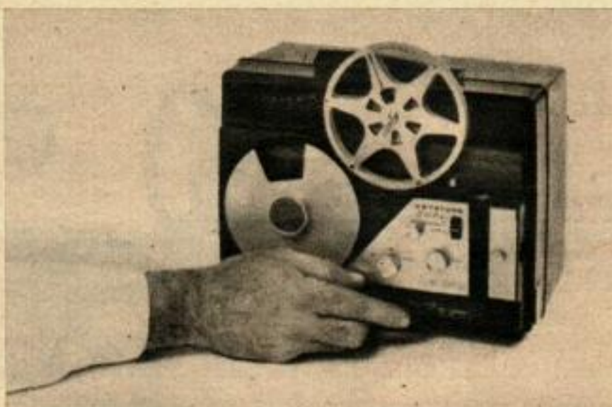
LE MODELE COMPACT DE KEYSTONE possède un seul bouton pour la marche avant, arrière, projection fixe et rebobinage. Sa bobine encastrée de 60 mètres et son couloir abrité rendent la mise en place automatique très sûre, mais le rebobinage difficile.
