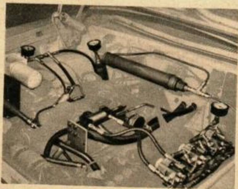
UN SYSTEME HYDRAULIQUE remplace sur cette voiture les tringleries d'accélérateur, de freinage et de direction.
